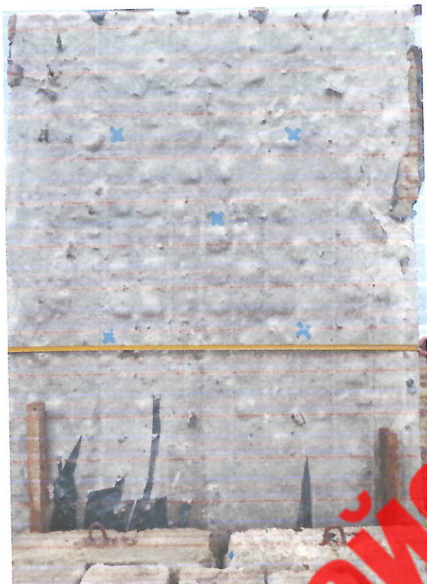
Залізобетонний елемент швидкоспороджуваної захисної споруди цивільного захисту модульного типу до випробувань (сторона обстрілу)
