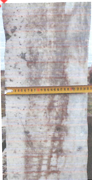
Залізобетонний елемент швидкоспороджуваної захисної споруди цивільного захисту модульного типу до випробувань (бокова сторона)
