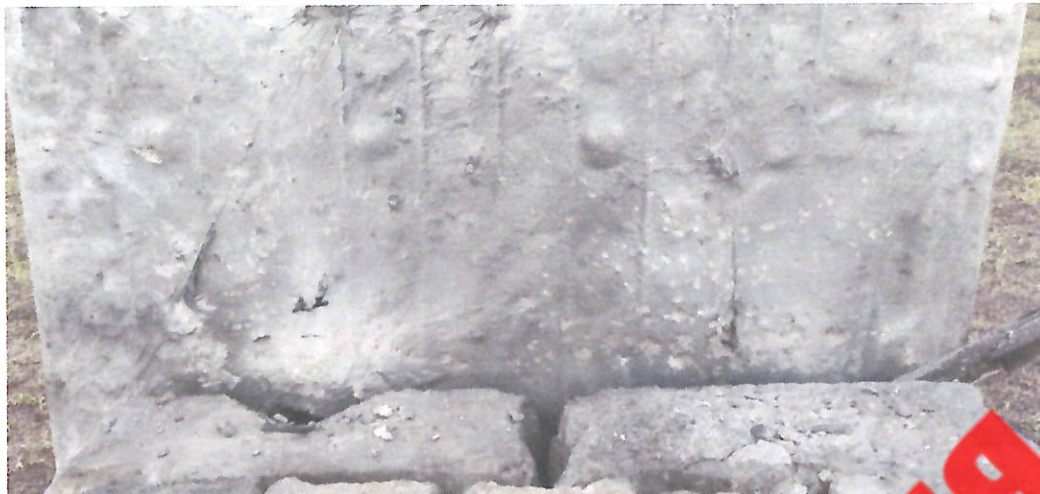
Залізобетонний елемент швидкосторуджуваної захисної споруди цивільного захисту модульного типу після випробувань (сторона підриву гранат РГН)
