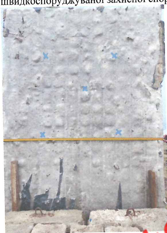
Залізобетонний елемент швидкоспороджуваної захисної споруди цивільного захисту модульного типу до випробувань (сторона підриву гранат РГН)
